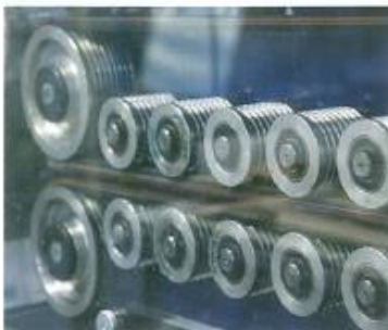
Tyto dva pásy zajišťují odtah hadice. Každý z nich je poháněn servomotorem EMMS s převodovkou EMGA, řízeným ovladačem CMMP.
