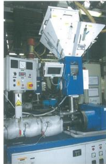
Extrudér, ve kterém se granulát roztaví na teplotu přes 200 °C a homogenizuje.
