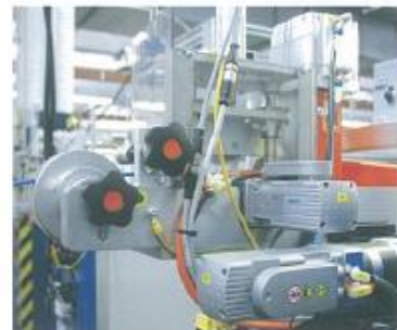
Vstupní část do navíječe hadic, která je vybavena pomocným podávacím pásem, příčným rozváděním návinu a automatickým střihem požadované délky návinu na cívku.
