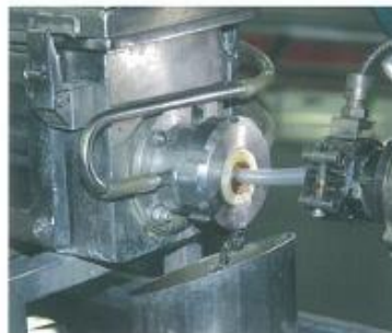
Hadice vycházející z hlavy je v této chvíli ještě nestabilní a zásadní vliv má právě rychlost odtahu.
